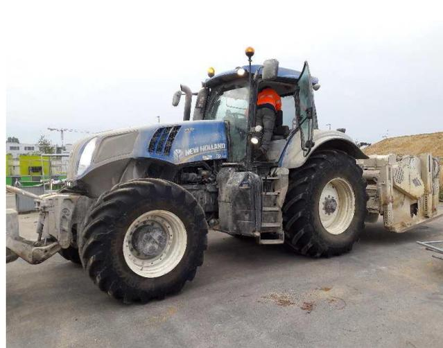
Broyeur avec denture renforcée
