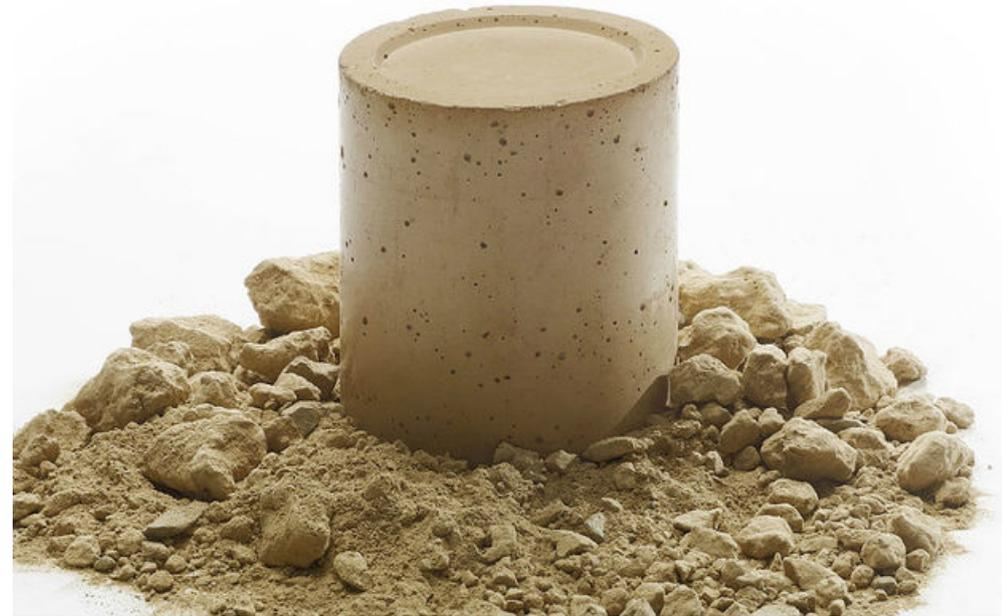
Le béton d'argile permet de diminuer par 2 le besoin en sable
